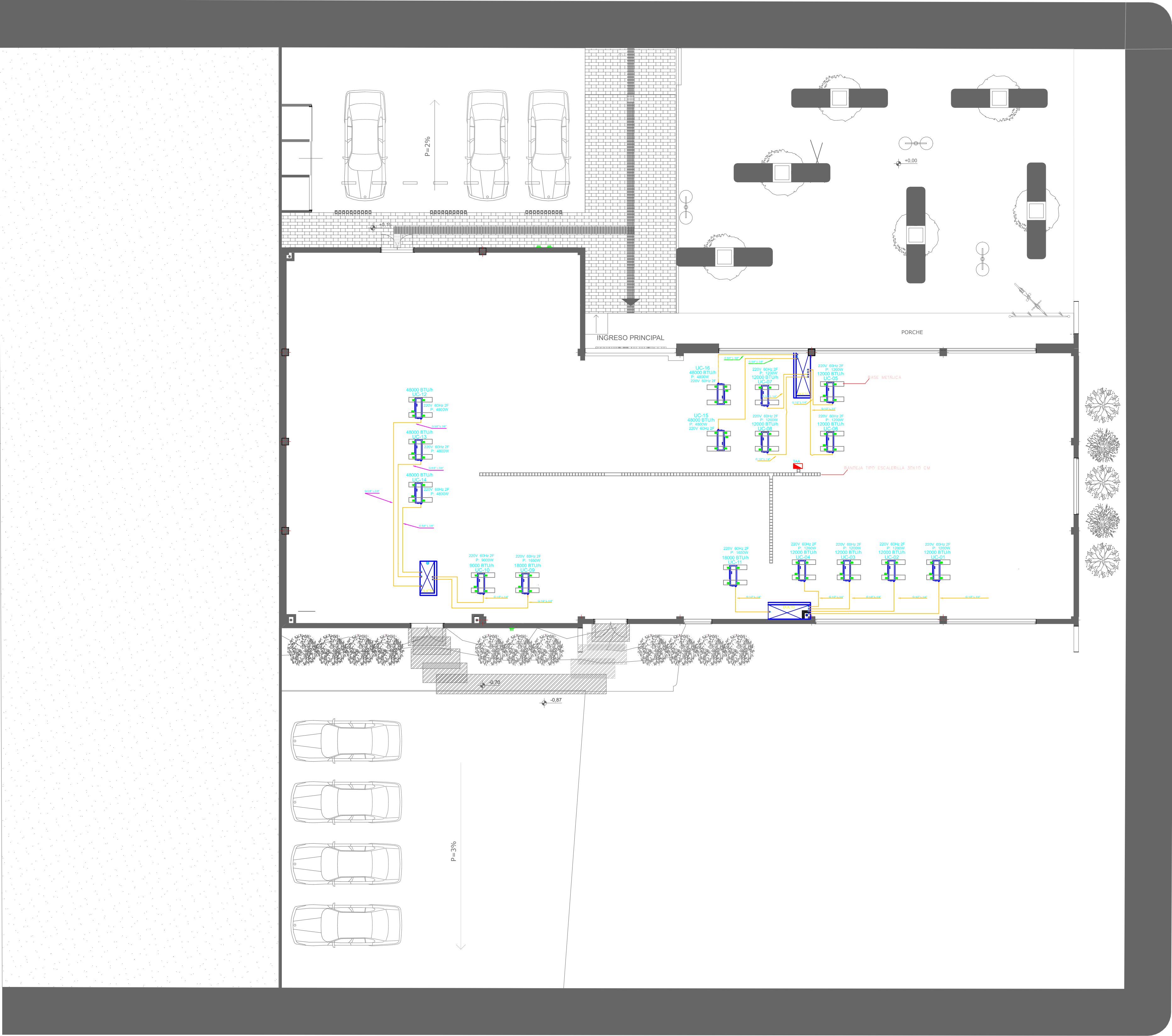
CONDENSADORAS Y TUBERÍAS ESCALA 1:100
